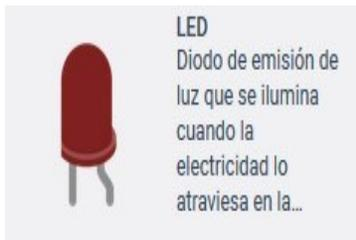
Un LED (siglas en ingles Light-Emitting Diode) es un tipo particular de diodo que emite luz al ser atravesado por una corriente eléctrica. Un diodo es una unión de dos materiales semiconductores con dopados distintos. Esta diferencia de dopado hace que genere una barrera de potencial, Los diodos tienen polaridad, es decir, solo
