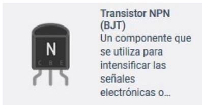
Un transistor puede trabajar de dos maneras: Permitir o cortar el flujo de corriente y amplificando una señal de entrada. Cuando un transistor funciona de la primera manera, en
