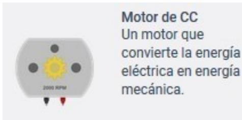
Un motor de corriente continua, que gira producto del campo magnético que se produce en su bobina interna al transmitirle corriente eléctrica. El estator es la parte mecánica del
