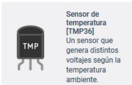
El sensor analógico TMP36 es un sensor de temperatura que es simplemente un chip de bajo consumo de energía que nos devuelve un valor de tensión proporcional a la temperatura del medio, en grados centígrados. Este dispositivo funciona a bajos niveles de voltaje y su baja
